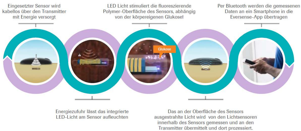
Abbildung 3: Messtechnik des Eversense® Systems
